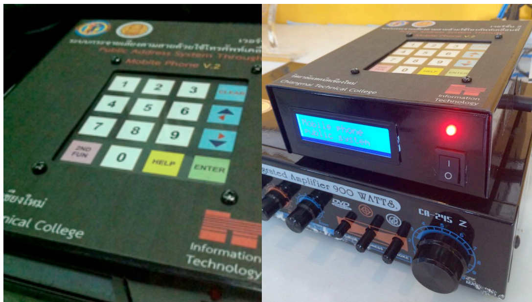
รูปที่ 4 บรรจุมicroคอนโทรลเลอร์ ตัวรับสัญญาณโทรศัพท์ และรีเลย์ ลงกล่อง
