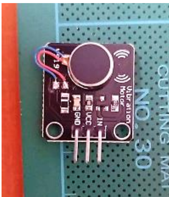
ภาพที่ 2.1 การทำงานของมอเตอร์สั่น DC
