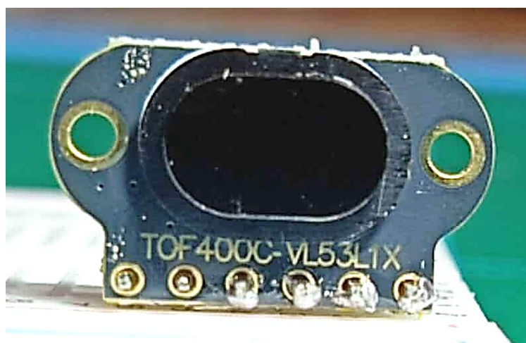
ภาพที่ 2.4 การทำงานของเซ็นเซอร์วัดระยะ VL53L1X
